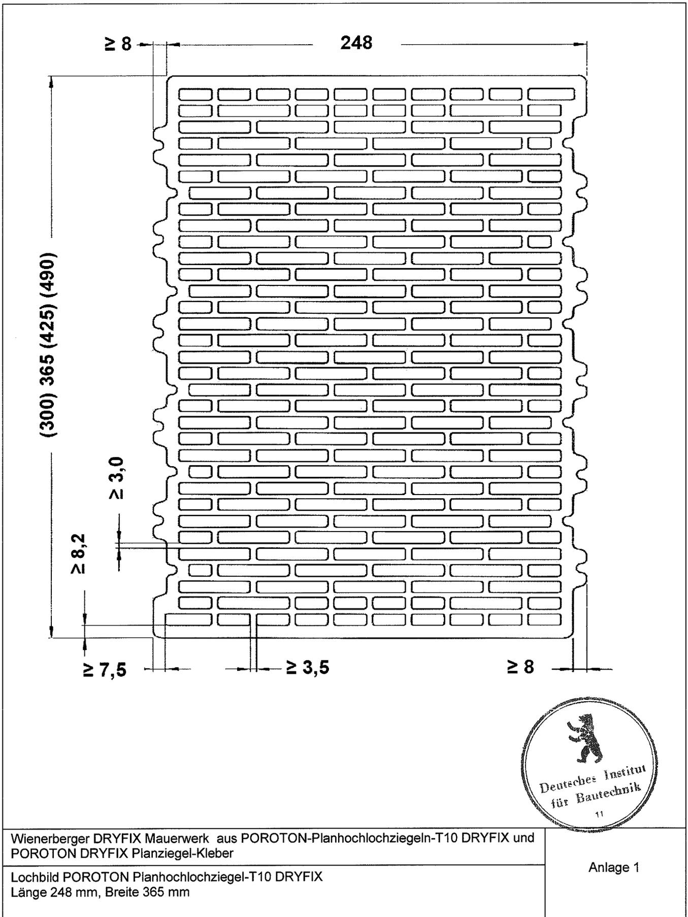
Wienerberger DRYFIX Mauerwerk aus POROTON-Planhochlochziegeln-T10 DRYFIX und POROTON DRYFIX Planziegel-Kleber
